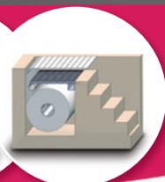
Exemple de configuration avec motorisation en coffre sec.
